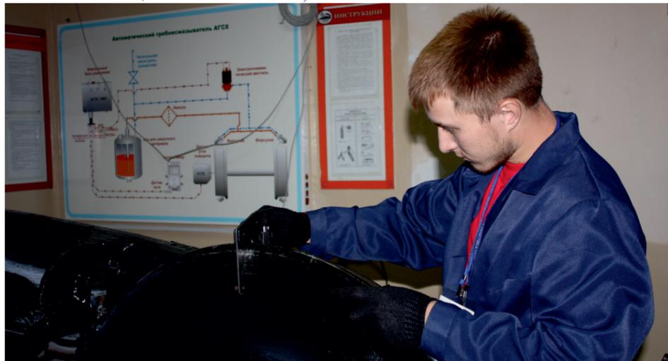
Модуль Д. Управление автотормозами. В ходе выполнения участникам предстояла разборка и сборка крана машиниста, а также проверка действия крана машиниста
