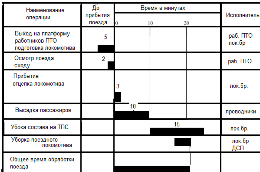
Рис.3.7 – Технологический график обработки поезда по прибытию на станцию приписки тупикового типа
