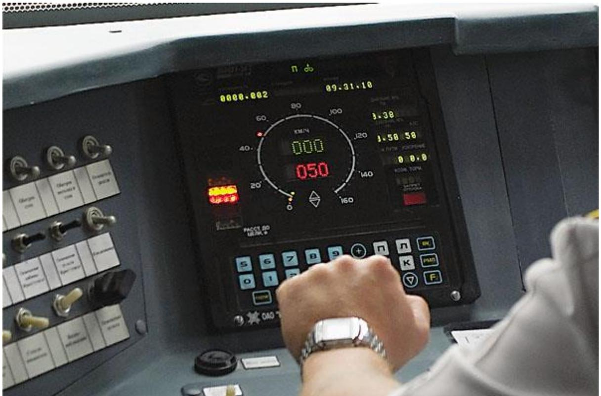
*Рисунок 34 – Комплексное локомотивное устройство безопасности*
