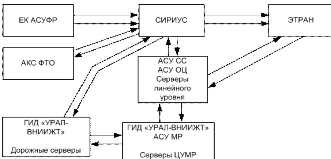
Рисунок 3 – Функциональное взаимодействие системы СИРИУС с другими системами
