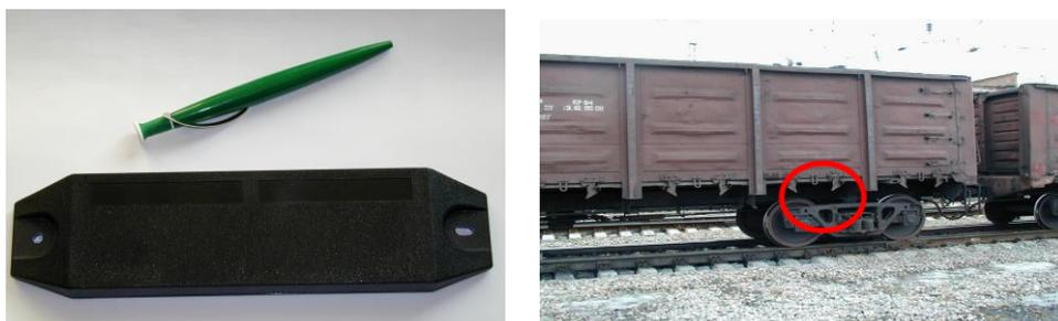
Рисунок 12 – Кодовые бортовые датчики
