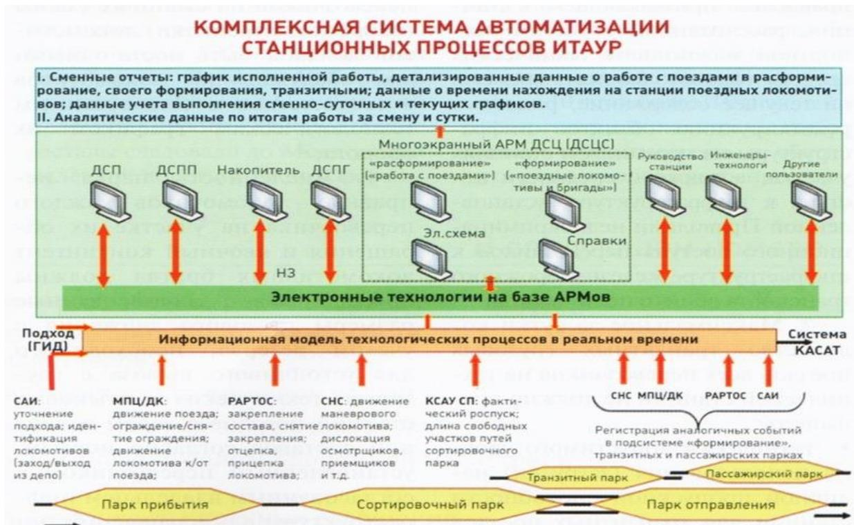
Рисунок 33 - Комплексная система автоматизации станционных процессов ИТАУР
